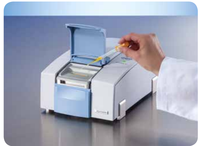
Abb. 4: Das ATR-Multireflexionsmodul erlaubt die Erfassung von Konzentrationen um ca. 1%.
