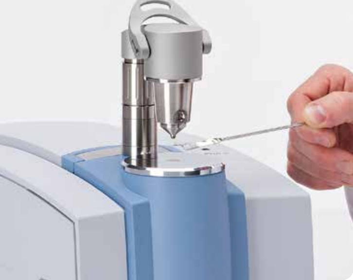
Abb. 1: Aufbringung der Probe auf dem Diamant ATR-Kristall zur Vermessung mit dem FT-MIR Spektrometer ALPHA II.
